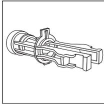
**5** Para volver a colocar el filtro, o instalar un nuevo filtro, asegúrese primero de que el filtro esté orientado adecuadamente con la pestaña de plástico hacia arriba. Si el filtro no está orientado adecuadamente, la pestaña que sobresale evitará que el filtro se vuelva a deslizar hasta su sitio.
