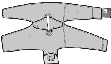
تأكد من أن المبادل الحراري مسطح داخل الكم دون ثنيات أو تجعدات. أغلق سحاب الكم إذا وجد. بعد التجمیع، ضع الجانب الأزرق للأعلى وتأكد من أن المبادل الحراري متندب بشكل متسق وسوسي داخل الكم.
