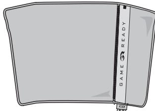
3 تأكد من أن المبادل الحراري مسطح داخل الكم دون ثنيات أو تبعيدات. أغلق سحاب الكم إذا وجد. بعد التجميغ، ضع الجانب الأزرق للأعلى وتتأكد من أن المبادل الحراري متمد بشكل منشق وسوي داخل الكم.
